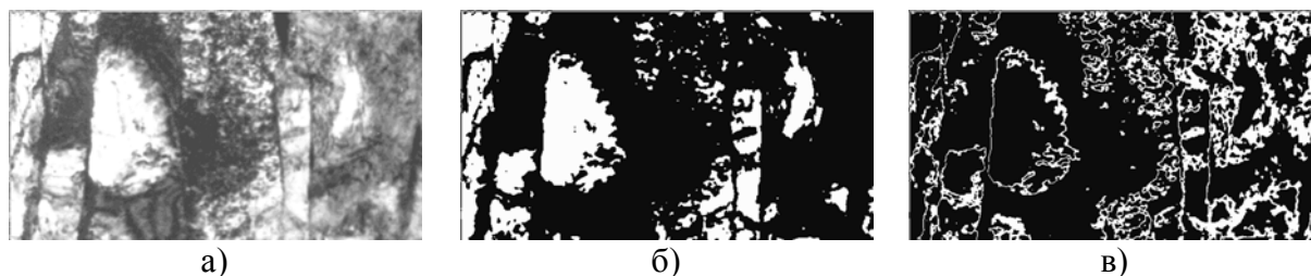
Рис. 2. Пример исходного полутонового изображения дислокационной структуры в стали в 256-и уровнях «серого», зафиксированного на экране электронного микроскопа (а) и варианты его бинарного отображения в зависимости от выбранных порогов бинаризации: порог 152–255 (б) и порог 84–134 (в) [21].
