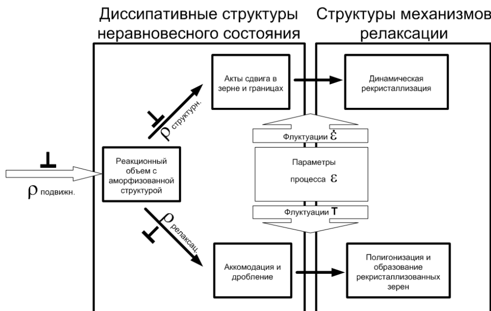
Рис. 7. Возможные стадии структурных преобразований с образованием диссипативных структур и активацией механизмов релаксации.
