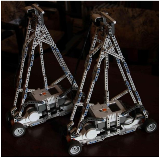
Рис. 7: фотография двух маятников на тележке собранных из робототехнического конструктора Lego Mindstorm NXT 2.0.
